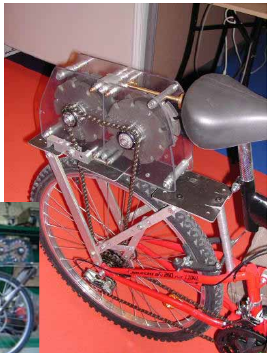
Photo : schéma et vélo avec une assistance d'engrenages magnétiques pour découpler la force de traction.
